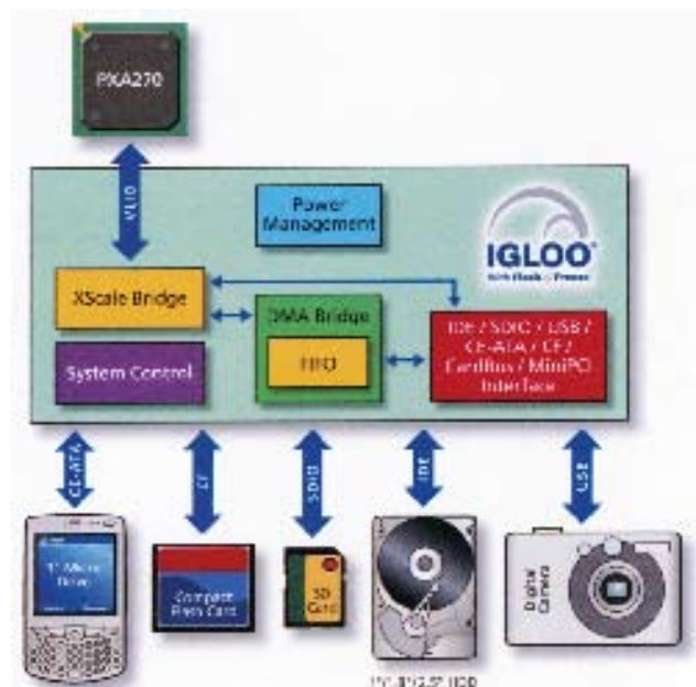
Det meget lave statiske effektforbrug gør Igloo FPGA'erne velegnede til batteridreven, håndportabel elektronik
