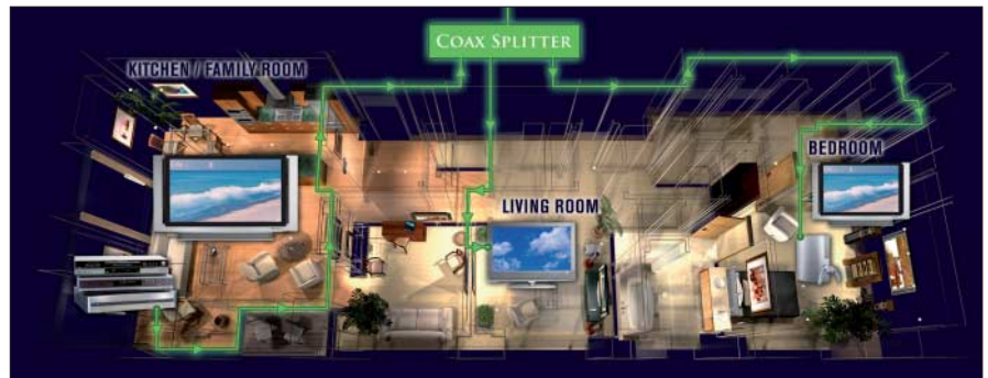
Pulse Link verteilt HDTV im ganzen Haus, entweder wie hier gezeigt über das vorhandene Koaxialkabelnetz oder über Ethernet bzw. Wireless. (Bild: Puls Link)
